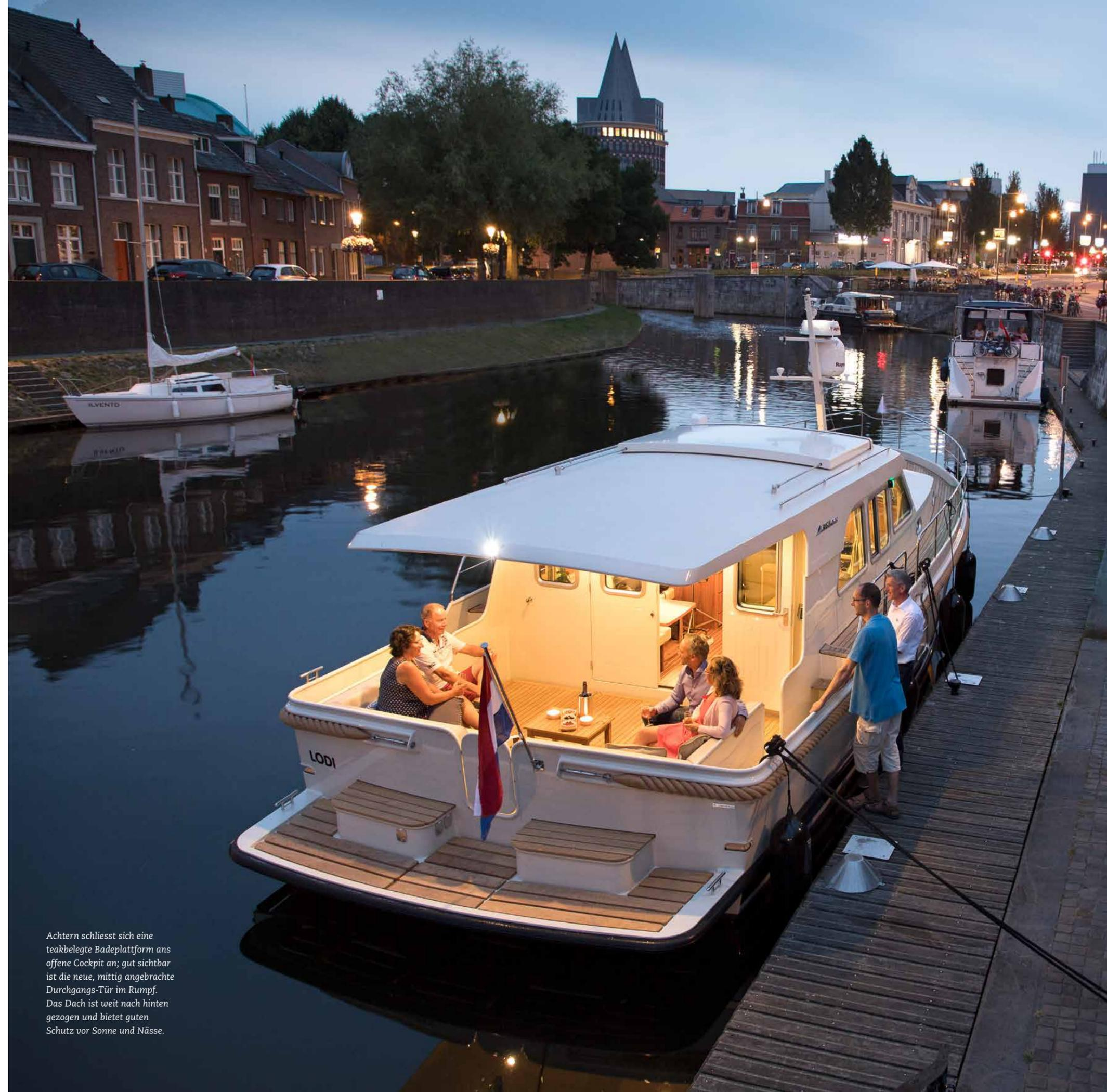
*Achtern schliesst sich eine teakbelegte Badeplattform ans offene Cockpit an; gut sichtbar ist die neue, mittig angebrachte Durchgangs-Tür im Rumpf. Das Dach ist weit nach hinten gezogen und bietet guten Schutz vor Sonne und Nässe.*
